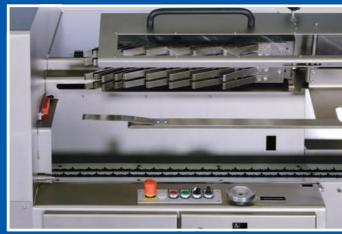
Zur einfachen Reinigung und Wartung lässt sich die Schutzhaube öffnen und ermöglicht so den optimalen Zugriff zur Transportund Messereinheit.
