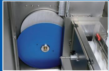
Die **Rotec 2000** ist auch im Doppelbahnmodus mit verdoppelter Kapazität zu betreiben und bietet mit dem beölten Kreismesser einen schonenden Schneidprozess.
